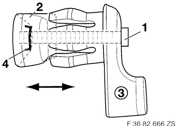
Innensechskantschraube (1) ggf. herausdrehen bis der Konus (2) der Halterung (3) an der Haltescheibe (4) am Gewinde anliegt.
