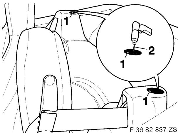
Abdeckkappen (1) mit Bohrer (2) ø = 8mm durchbohren. Anschließend die Abdeckkappen (1) mit einer Zange aushebeln.
