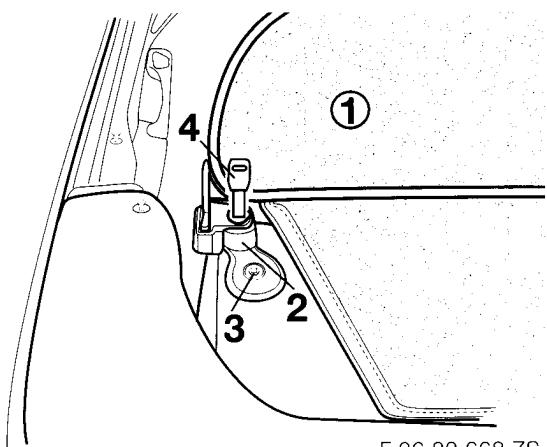
Windschutz (1) einstecken, Halterungen (2) ausrichten, nach unten drücken und festschrauben.
