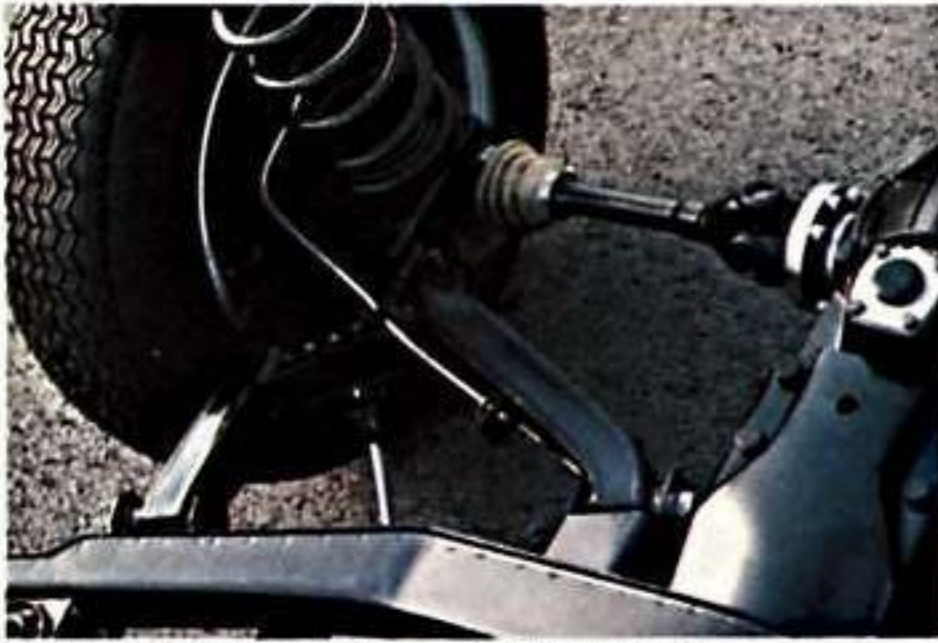
BMW Hinterachse: schräggestellte Längsschwingen
